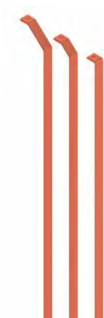
Detalhe do barramento vertical para gavetas extraíveis
