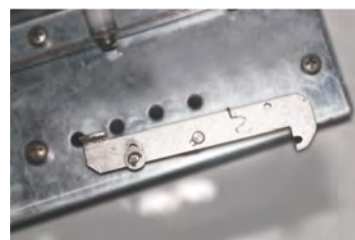
Dispositivo de segurança anti-queda quando da remoção da gaveta.
