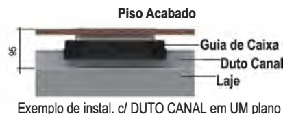
Exemplo de instal. c/ DUTO CANAL em UM plano
