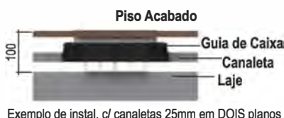
Exemplo de instal. c/ canaletas 25mm em DOIS planos
