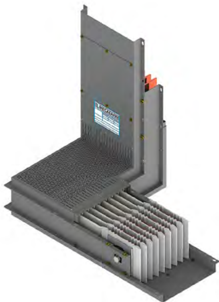
MV - BARRAMENTO VENTILADO CORRENTE: 630A - 6.000A GRAU DE PROTEÇÃO: IP31 CONDUTOR: COBRE - ALUMÍNIO CLASSE DE TENSÃO: 1kV NBR IEC 60439-1/2
