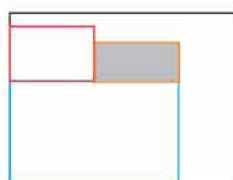
Coluna de distribuição 800 mm COM coluna de cabos
