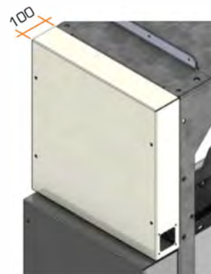
Caixa de passagem para interligação das colunas.
