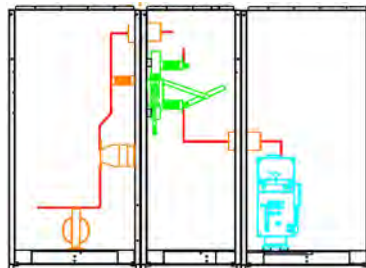
Entrada direto na coluna medição, coluna com seccionadora a ar e coluna com disjuntor comando lateral.
