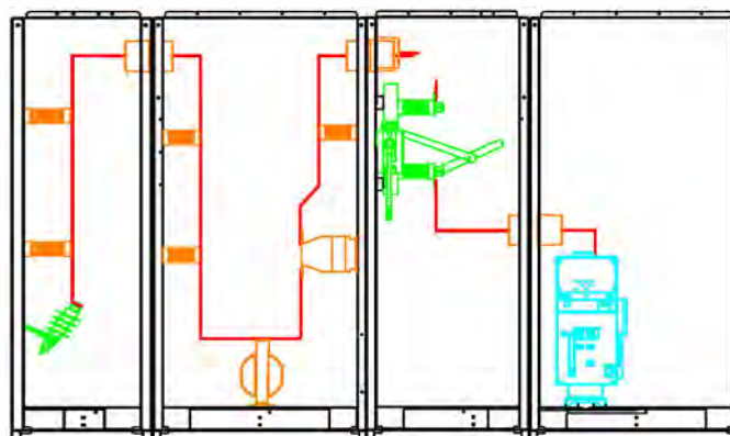
Entrada coluna auxiliar, coluna de medição, coluna com seccionadora a ar e coluna com disjuntor comando lateral.
